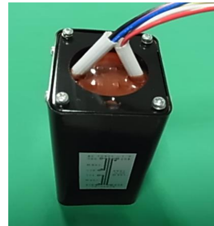
85) BTS ケース入れトランス例
